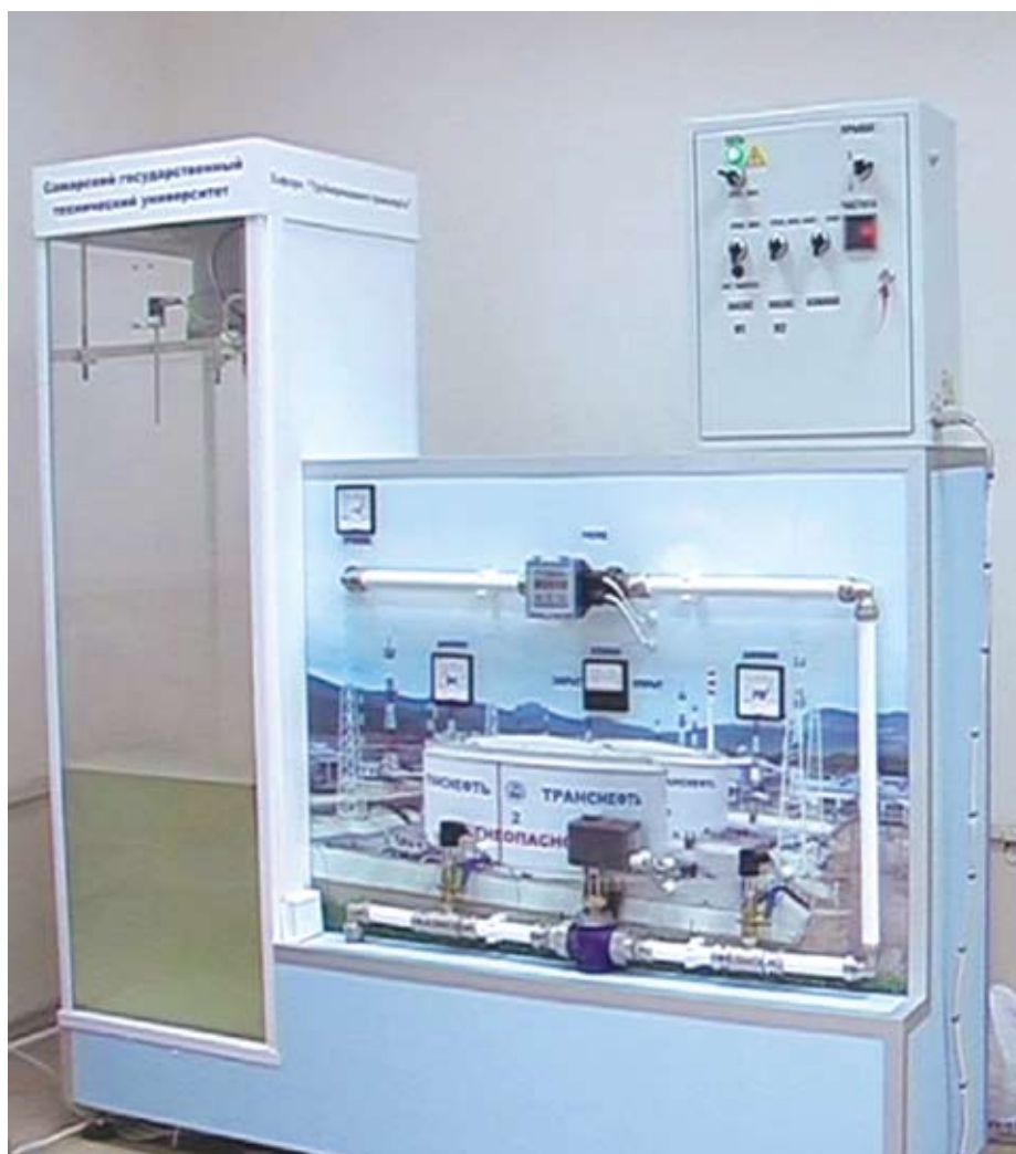
рисунок 10. Стенд приборного оборудования и автоматики
